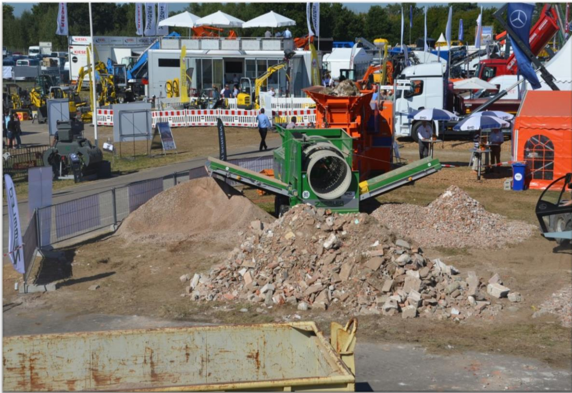
Figura 156 – Tecnologia móvel para tratamento e reaproveitamento dos resíduos da construção e demolição civil RCD
