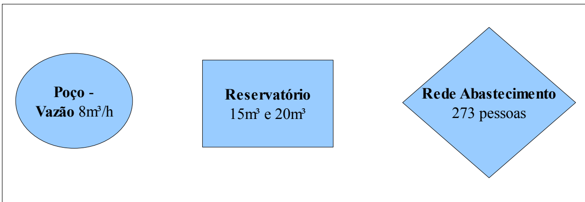
Figura 4.16: Fluxograma do sistema de abastecimento
